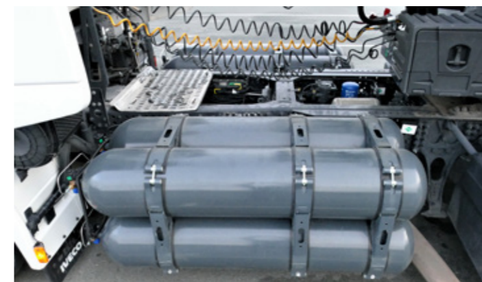
V jeklenke na obeh straneh šasije gre 250 kilogramov stisnjene zemeljskega plina. Edina pomanjkljivost z zunanje strani je odstopajoča barva na pohodni aluminijasti pločevini za kabino.
