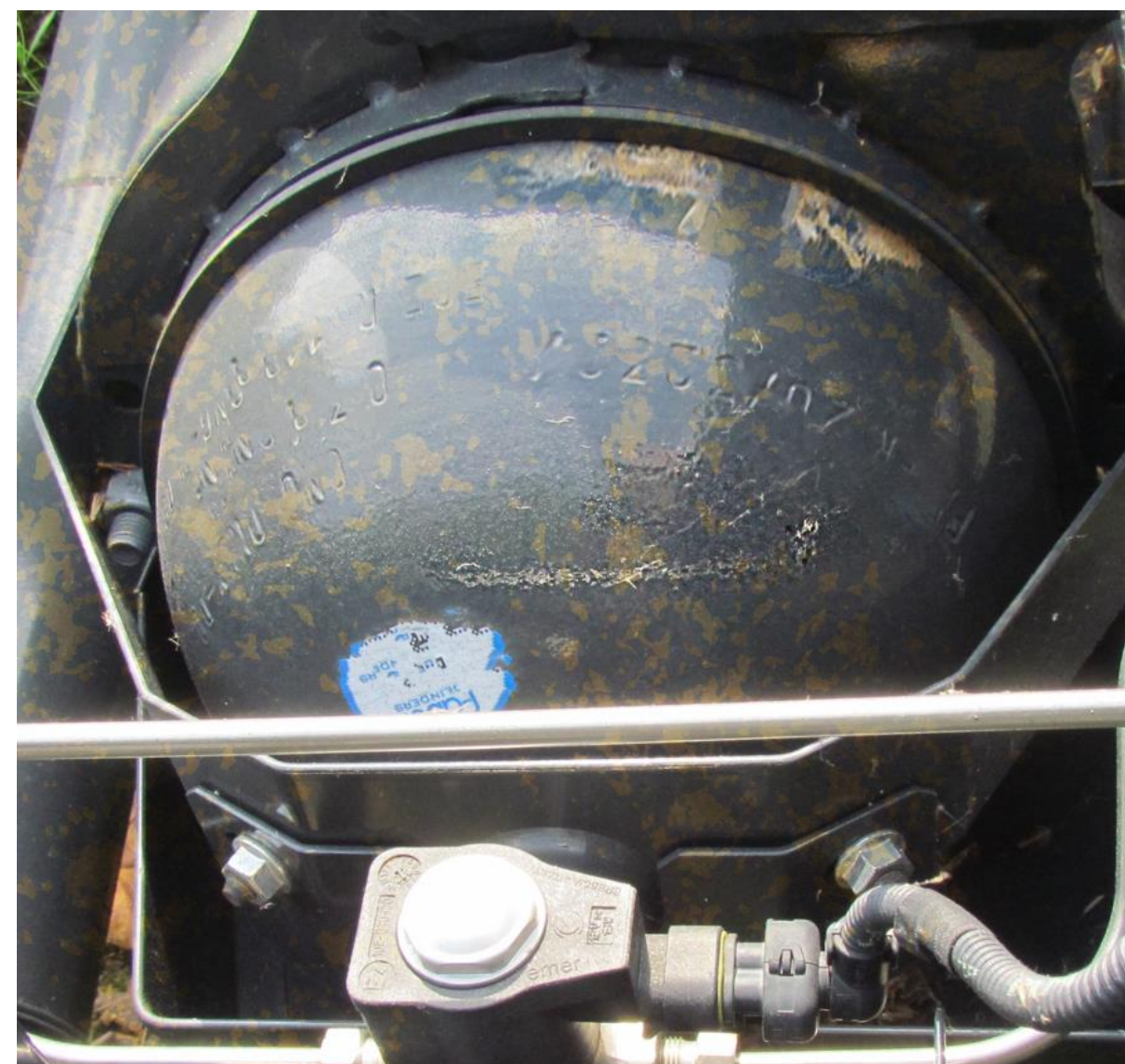
Originalne identifikacijske oznake na CNG cilindru koje su odsutne ili nečitljive → naknada za zamjenu CNG spremnika novim spremnikom.
