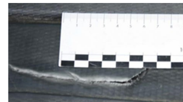
Perforacije na oblogama tvrde plastike. Za popravak obloga od tvrde plastike potrebno je 1 sat fiksno, ako je to estetski prihvatljivo i može se popraviti
