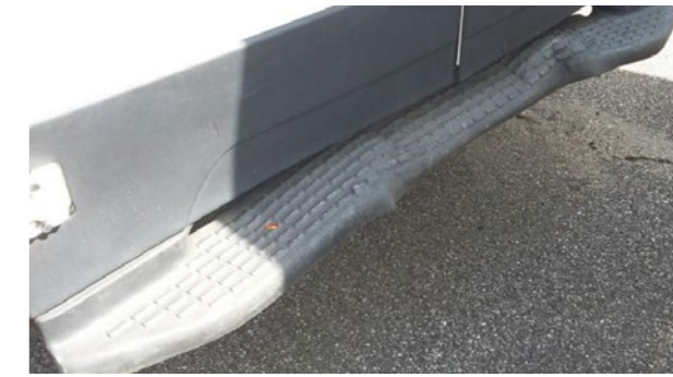
🔄 Stražnje stepenice: Deformacije koje ne spadaju u ekonomski isplativ popravak
