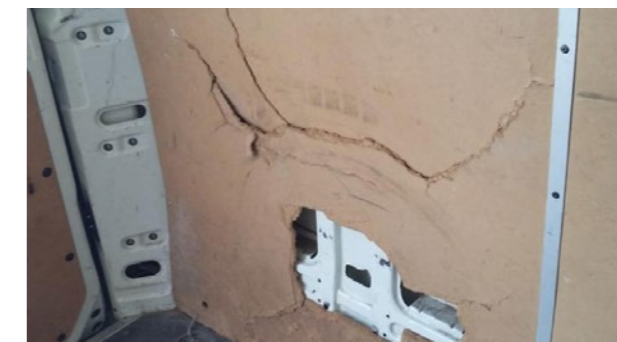
🔄 Interni drveni štitnici: Udraci, puknuta ploča, ploča koja nedostaje (osim gornjih ploča vrata)
