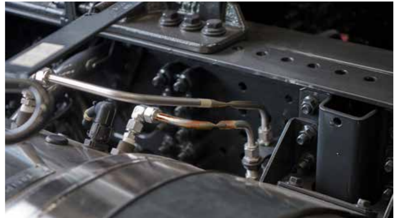
Hrđa, udubljenja, pukotine i/ili utori → naknada za zamjenu cijevi.
