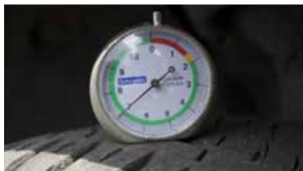
Gume: dubina osnove utora \geq 7 mm (U SKLADU) Napomena: Istrošenost guma mjeri se na najviše istrošenom utoru gume.
