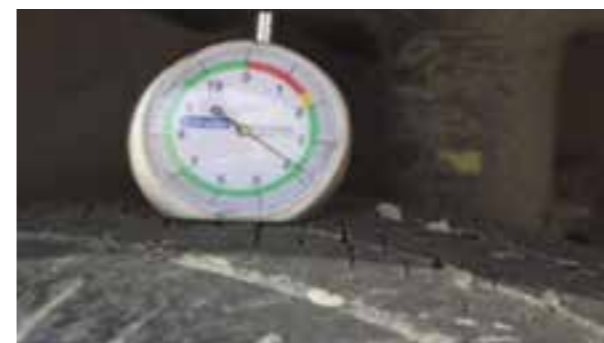
Gume: dubina osnove utora < 7 mm Napomena: istrošenost guma mjeri se na najviše istrošenom utoru gume.
