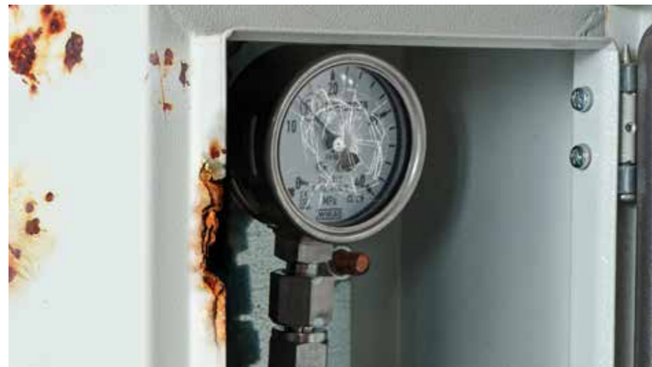
Odsutnost ključa zaštitnog kućišta, oštećeni poklopac za CNG ili manometar → naknada za zamjenu cijelog kućišta.
